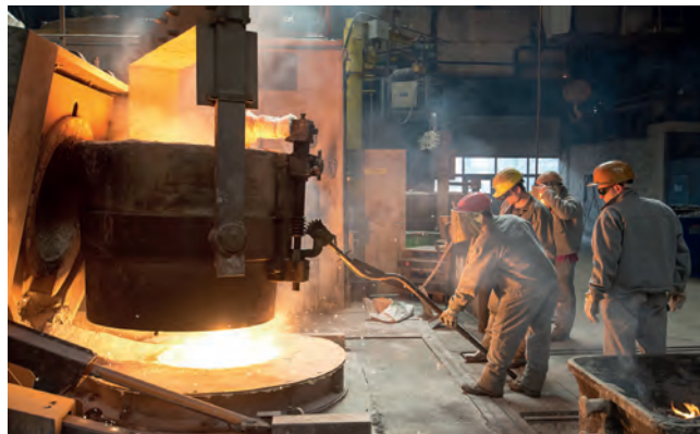
Выпуск чугуна из доменной печи
